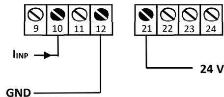
**Abbildung 11: Klemmenbelegung Messkopf Stattox 501 Infratox / Infratox HS**
