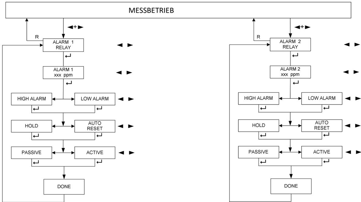
Abbildung 8: Konfiguration der Alarmrelais
