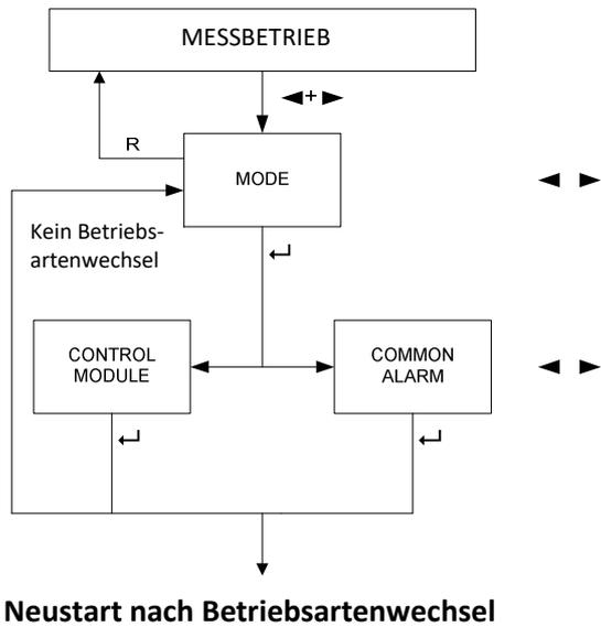
Hier kann die Betriebsart des Statox 503 gewählt werden. Standardmäßig wird der Statox 503 als Control Modul ausgeliefert.
