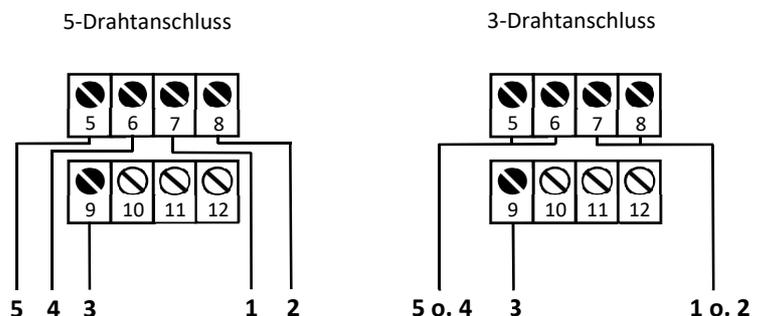
**Abbildung 12: Klemmenbelegung der Messköpfe Stattox 501 HRC, ARE, LCIR, MCIR, CO<sub>2</sub> und PID**
