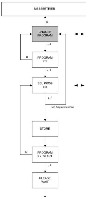
In diesem Menüpunkt kann das spezifische Betriebsprogramm für einen Messkopf eingestellt werden. Das Betriebsprogramm beinhaltet die Gasart, den Messbereich, die Grenzwerte für die Justierung und auch alle Standardalarmeinstellungen für die Relais. Siehe beigelegte Programmliste.
