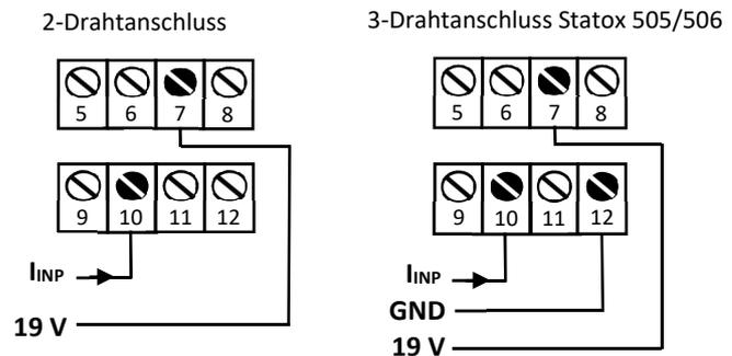
**Abbildung 10: Klemmenbelegung Messköpfe Stattox 501/S und Stattox 505/506**
