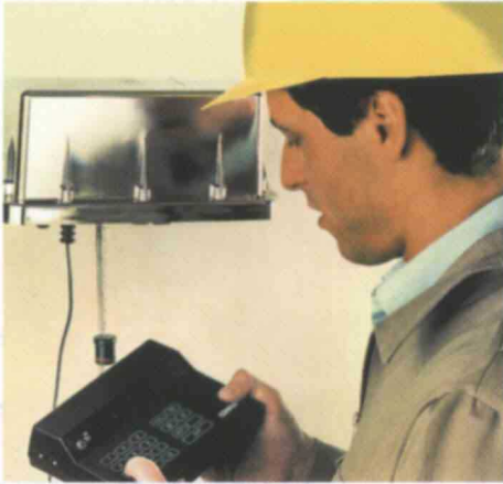
Diagnosebox: Einfache Kalibrierung und Fehlerdiagnose
